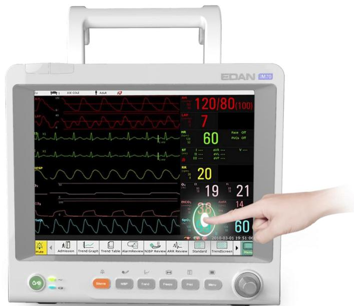
**Standartní Parametry:** 3/5-svodů EKG, SpO<sub>2</sub>, RESP, NIBP, 2-TEPLOTA, PR
